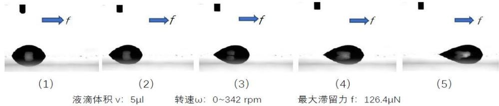
利用滞留力和动态接触角同步测量功能，可以分析滑动过程中滞留力和液滴形状变化等因素之间的相互关系
