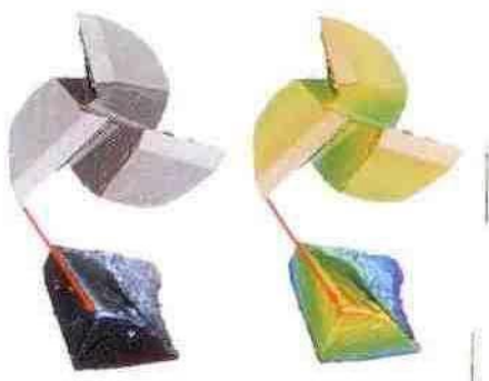
图2 陡峭斜面测量实例—钻头的三维表面形貌测量
